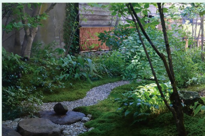
2025年8月。大谷石のかわりに伊勢砂利を敷いてある。境界に竹の垣根を設け、 隣家のブロック塀を湯涌の石で囲った石垣と杉皮貼りで覆った。
